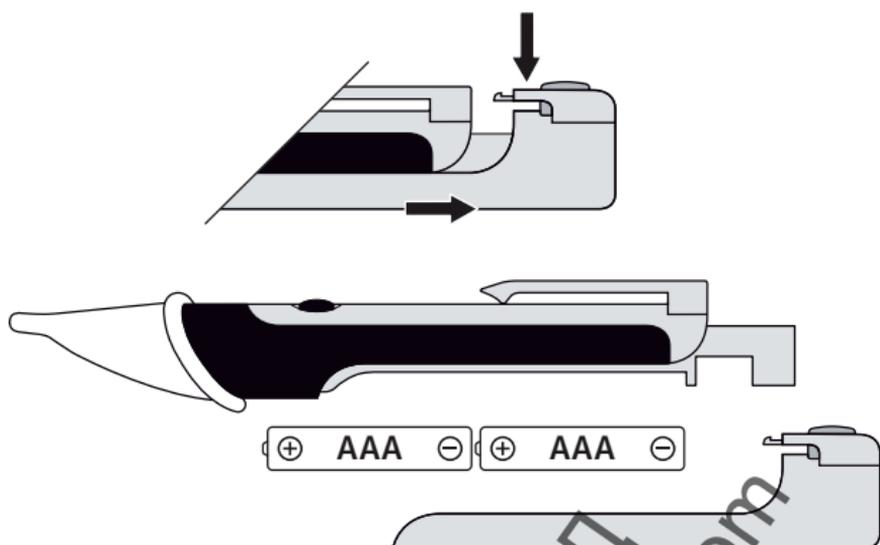
! Apparatens är klar att användas direkt efter att batterierna satts in. Den har ingen speciell PÅ/AV-omkopplare och är därför alltid aktiv.
