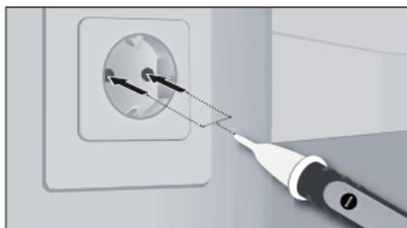
Proszę przyłożyć wierzchołek detektora do badanego obszaru (np. kabel, gniazdo elektryczne, itp.).
