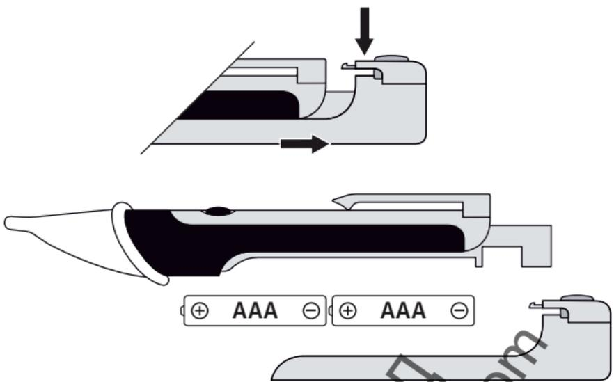
**!** Устройството е готово за работа веднага след поставяне на батериите. То не разполага с отделен превключвател Вкл/Изкл и поради това винаги е активно.
