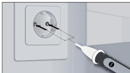
Nasadte hrot detektoru na měřenou oblast (např. kabel, zásuvka atd.).
