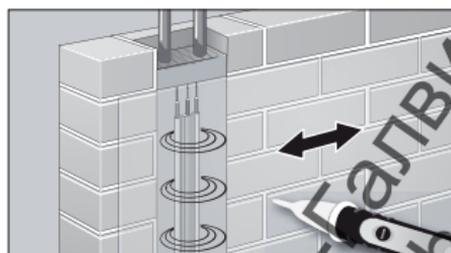
Mit gedrückter ZOOM-Taste erhöht sich die Empfindlichkeit des Gerätes (24 VAC bis 1000 VAC). So können Spannungsfelder auf größere Distanz lokalisiert werden, indem das Gerät über den zu prüfenden Bereich bewegt wird.
