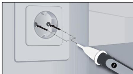
Poser la pointe du détecteur sur la zone à contrôler (par ex. câble, prise, etc.).
