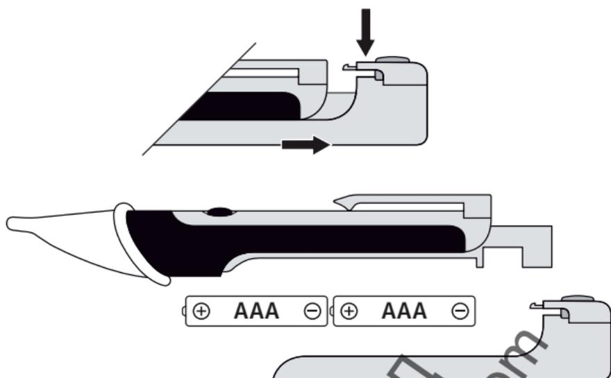
! Apparatet er klart til bruk umiddelbart etter at batteriene er satt inn. Den har ingen separat på/av-bryter og er således alltid aktiv.
