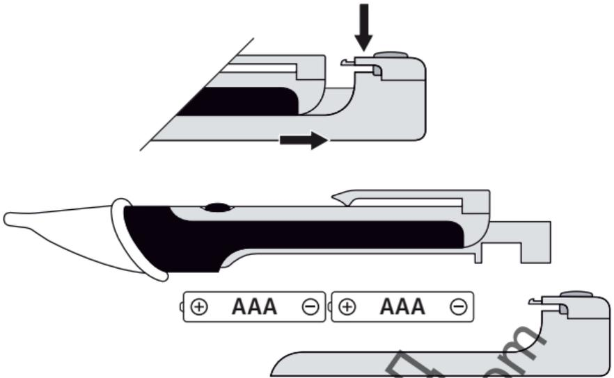
**!** El aparato está preparado para funcionar directamente después de colocarle las pilas. No dispone de interruptor de encendido y apagado, por lo que siempre está activo.
