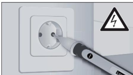
Pinge olemasolu korral süttib detektoritipp ja kõlab signaal.
