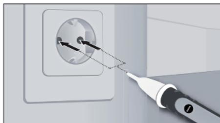
Pange detektoritipp kontrollitavasse piirkonda (nt kaabel, pistikupesa vms).
