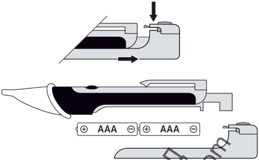
**!** L'appareil est immédiatement opérationnel après avoir mis les piles en place. Il ne dispose pas d'un interrupteur Marche/Arrêt séparé et est ainsi toujours activé.
